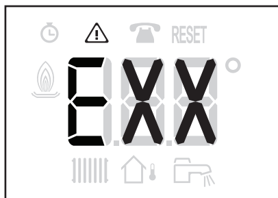
Рис.56 Индикация кода ошибки
